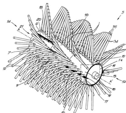
(017,007) Mobiele inrichting (1) voor het verwijderen van onkruid, die in hoofdzaak bestaat uit een chassis (2) waarop een cilindrische borstel (5) roteerbaar is aangebracht, daardoor gekenmerkt dat de cilindrische borstel (5) bestaat uit meerdere segmenten (6-11) met borstelharen (12), welke segmenten (6-11) zijn aangebracht op een as (13) die roteerbaar is opgesteld in het chassis (2).
