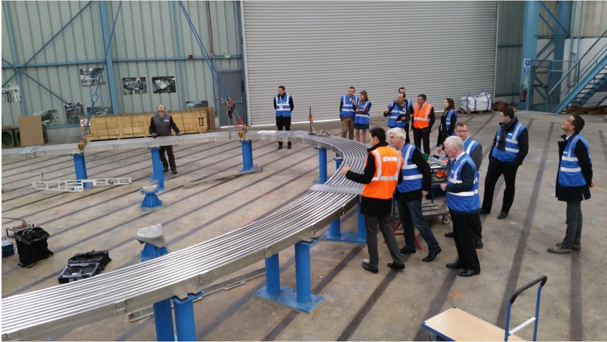
Bedrijfsbezoek aan CNIM, in de buurt van Marseille, waar de zgn. "radial plates" worden gemaakt voor de fabricage van de gigantische toroidale magneetspoelen
