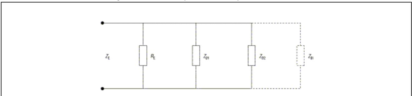
**Impédance de boucle d'une prise de terre  $Z_{EB}$ :** impédance du circuit formé par la résistance  $R_E$  de la prise de terre en série avec l'impédance  $Z_B$  que constituent tous les autres chemins de retour à la terre.
