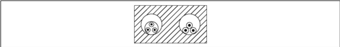
**Caniveau ou gaine de sol:** enceinte ou canal, situé au-dessous du niveau du sol ou plancher et dont les dimensions ne permettent pas d'y circuler: lorsqu'il peut être fermé, les câbles doivent être accessibles sur toute leur longueur.
