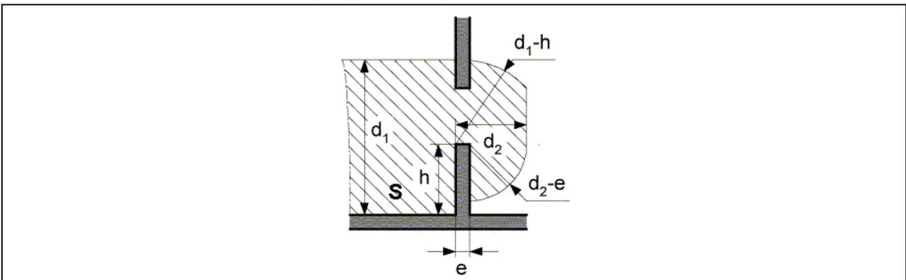
Figure 2.9. Volume d'accessibilité: des ouvertures existent dans les éléments matériels limitant la surface de circulation et ne permettent pas le passage d'une longue barre rectiligne de 12 mm de diamètre
