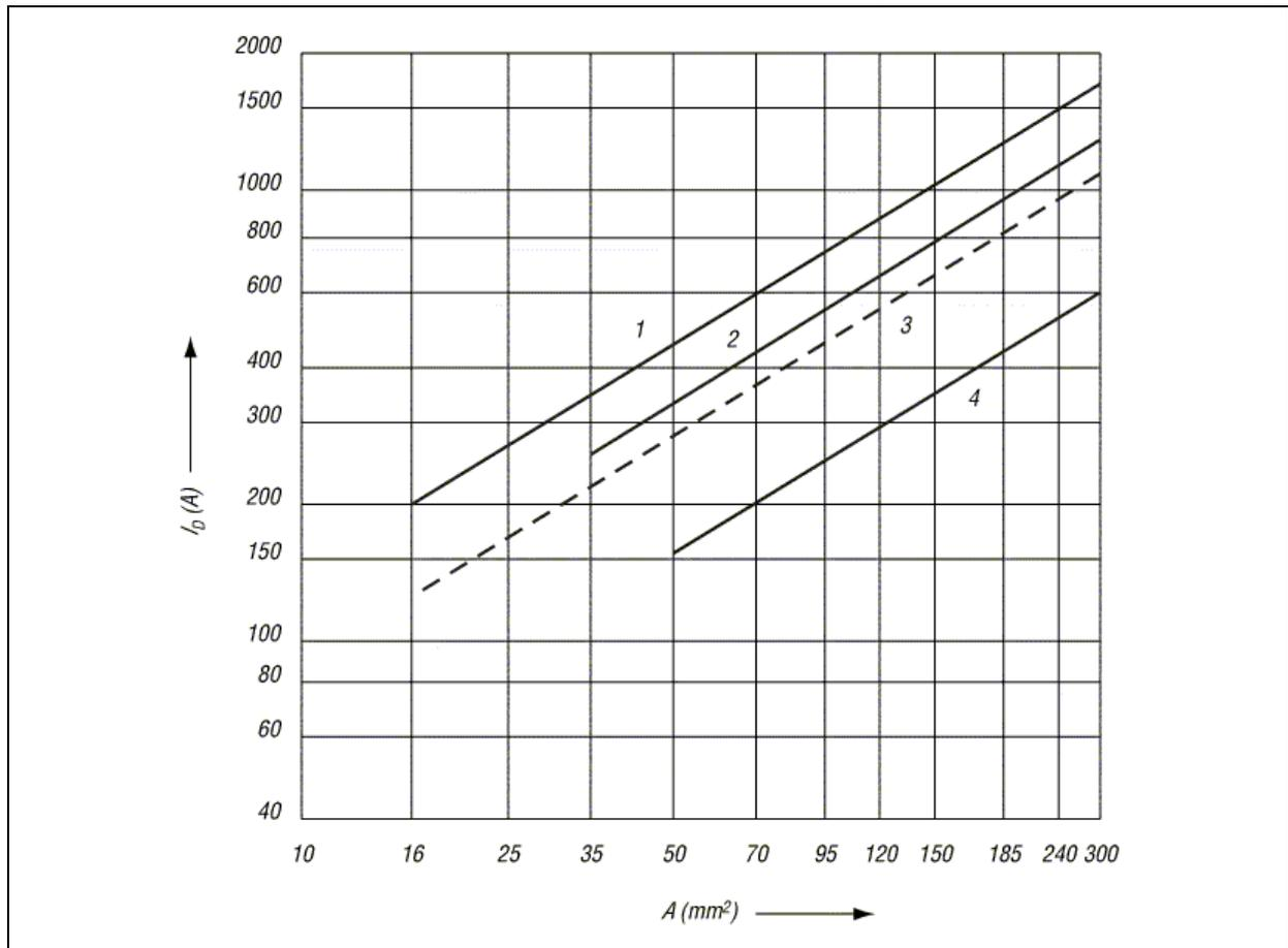
Les droites 1, 2 et 4 s'appliquent à une température finale de 300 °C; la droite 3 pour une température finale de 150 °C.
