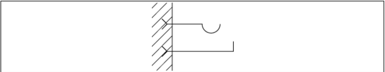
**Gouttière:** matériel de pose constitué par un profilé à parois pleines ou perforées, destiné à supporter des câbles en parcours horizontal et ouvert à sa partie supérieure.
