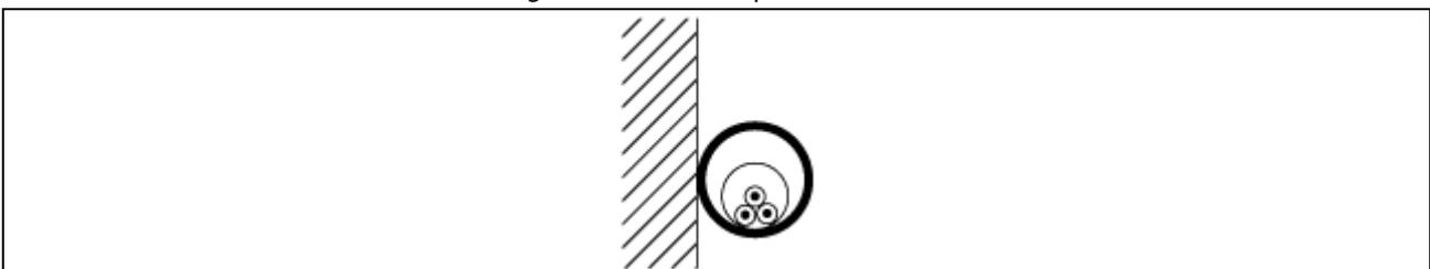
**Foureaux (ou buse):** élément entourant une canalisation électrique et lui conférant une protection complémentaire dans des traversées de paroi (mur, cloison, plancher, plafond) ou dans des parcours enterrés.
