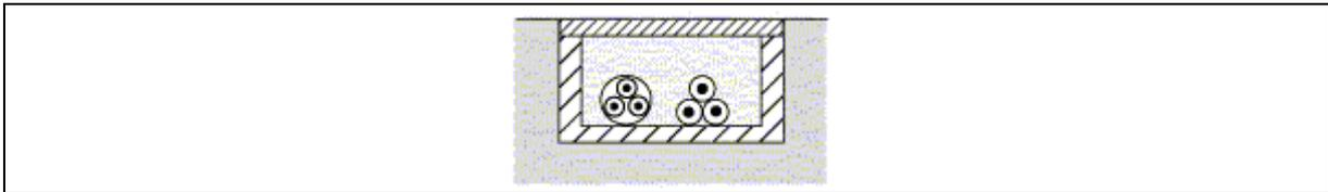
c. sous conduits à l'air libre, en galeries à câbles ou caniveaux, avec, si nécessaire, les moyens de fixation appropriés;
