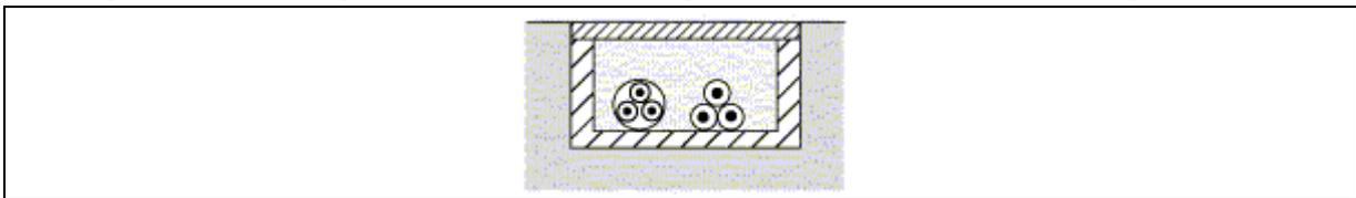
**i. dans les vides de constructions, alvéoles et blocs manufacturés;**
