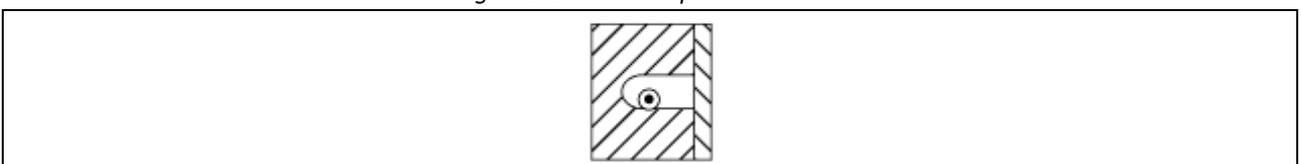
**Plinthe rainurée (ou chambranle):** plinthe (ou chambranle) comportant des rainures permettant le logement de conducteurs et éventuellement de câbles, et fermée par un couvercle démontable.
