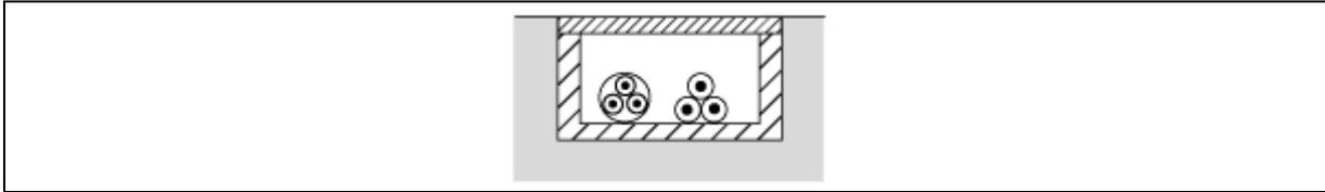
b.3. pose directe dans caniveaux remplis de sable
