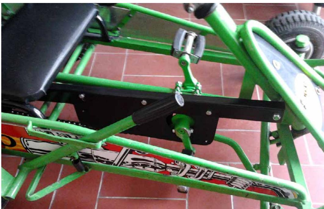
Exemples d'adaptations mal réalisées pour la protection de la chaîne et du pignon pour cuistax - speelgoed :
