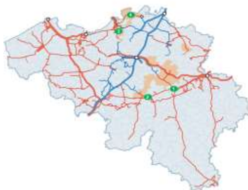
Figure 28 : programme indicatif de conversion au gaz H du réseau de transport de gaz L
