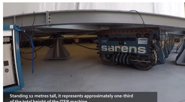
*Photo : Sarens déplace un élément du cryostat de l'atelier d'assemblage vers le parking extérieur.*
