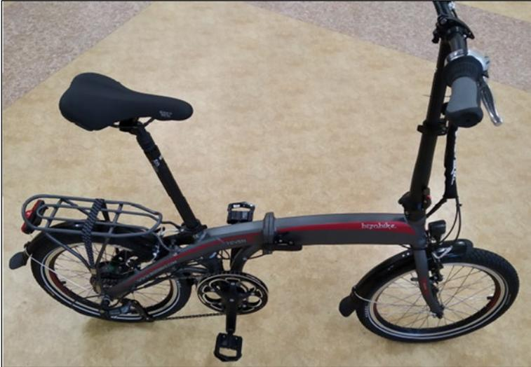
Le second vélo électrique ne respecte pas l'exigence en matière d'insertion de la tige de guidon. Ce modèle pliant présente un guidon de 1,5 cm dans le cadre en position maximale au lieu de 7 cm. De plus, divers marquages étaient manquants sur le corps du vélo. Enfin, la distance entre le levier de frein et le guidon était plus élevée que ce qui est prescrit par la norme correspondante. Le risque évalué est considéré comme élevé, le fabricant a accepté de retirer son produit du marché.
