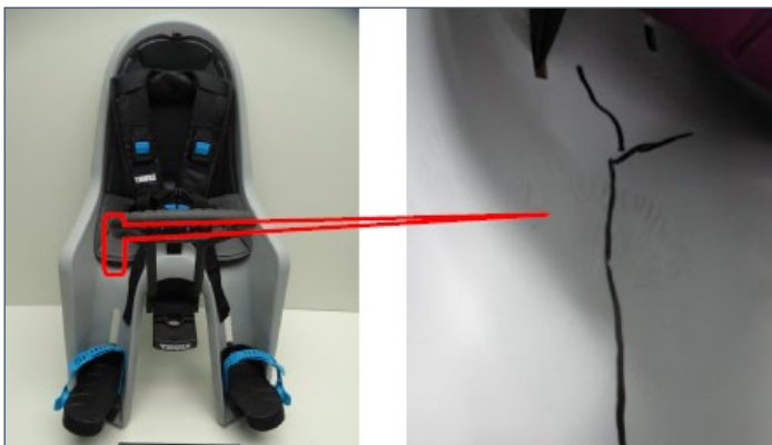
Photo 1. Coque fendue lors du test de durabilité
